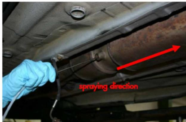
5. Nakon toga vratite senzor temperature ili diferencijalnog tlaka, te provjerite propuštanje.
