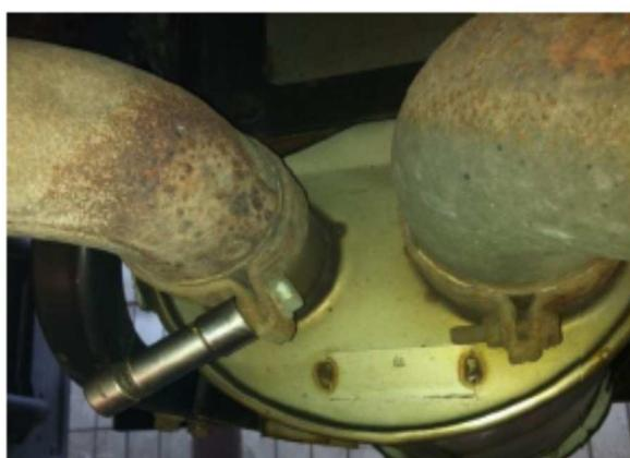
1. Skinite senzor tlaka ili odspojite filter ispušnih čestica od cijevi.
